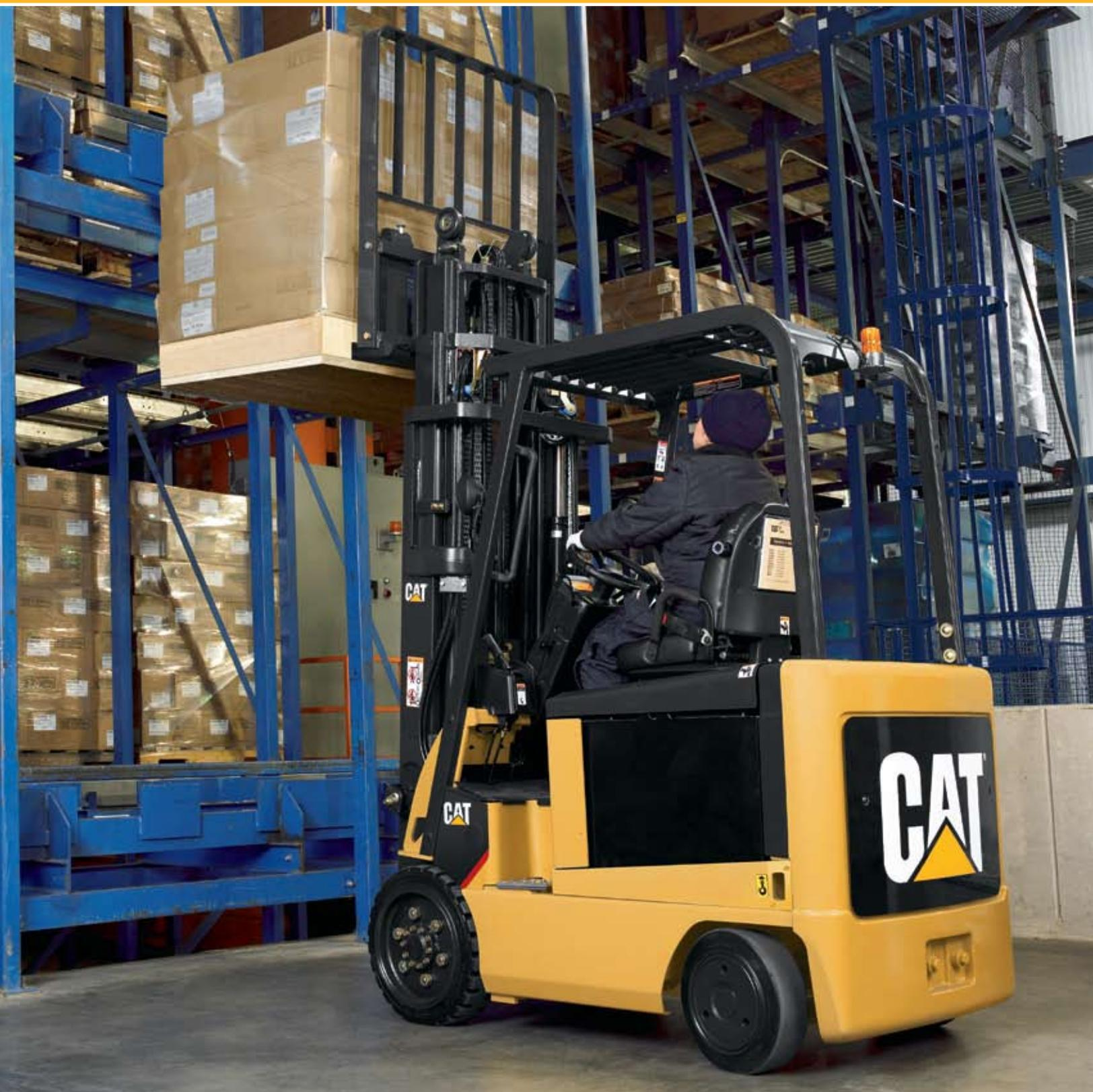
Estos montacargas ayudan a proporcionar una mayor visibilidad de las horquillas, cargas y del entorno laboral.
